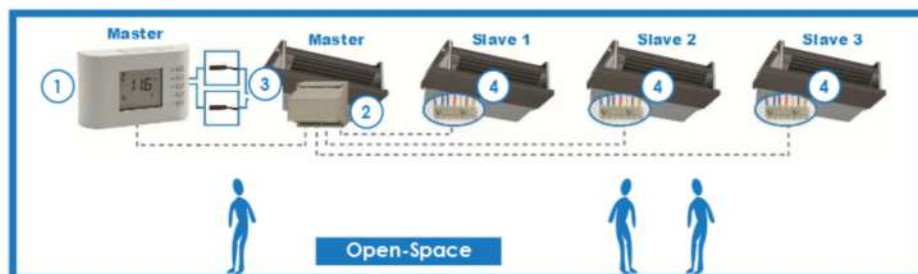
MASTER-SLAVE per la Regolazione di Open-space (per unità AC~230V 3Vel.) MASTER-SLAVE for the Open-space Regulation (for 3 speed AC~230V units)
